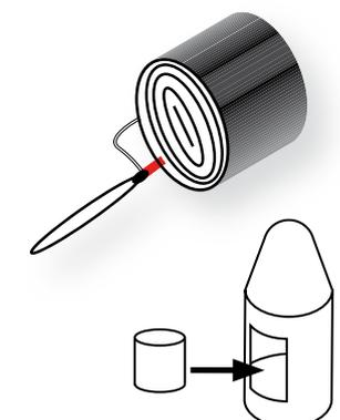
Der Fallschirm kann jetzt am Schockband befestigt und anschließend in die Fallschirmkammer gepackt werden.
